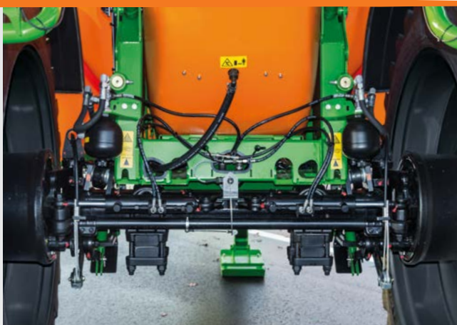
Suspension hydropneumatique d'essieu avec direction AutoTrail pour les UX 4201 et UX 5201
