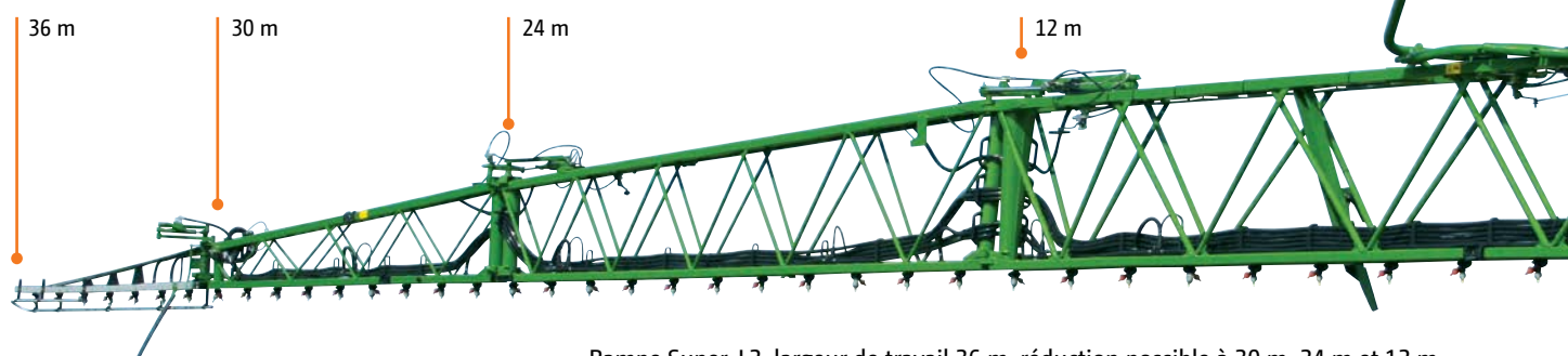
Rampe Super-L2, largeur de travail 36 m, réduction possible à 30 m, 24 m et 12 m
