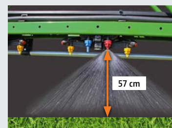
Buse 110° : Ecart entre buses 50 cm
