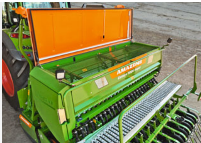
Les grilles dans la trémie protègent le semoir des corps étrangers et permettent d'y déposer des sacs de semences.
