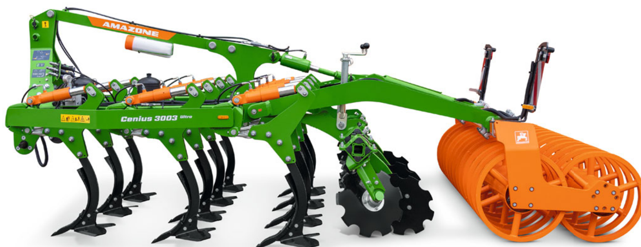
Cenius 3003 Ultra avec dents C-Mix-Ultra et sécurité non-stop hydraulique
