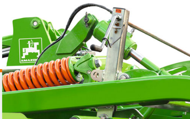
Réglage de hauteur des éléments de nivellement par manivelles sur le Cenius TX
