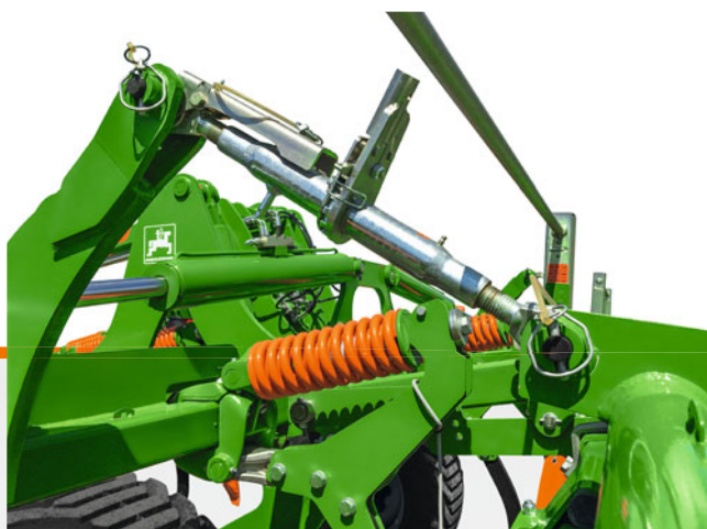
Réglage mécanique de la profondeur de travail sur le Cenius 03-2TX
