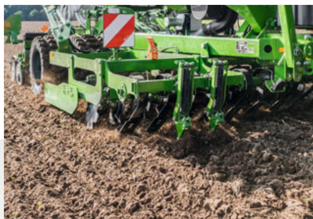
Combiné Crushboard et efface-traces de roues du tracteur monté sur le châssis du Cirrus
