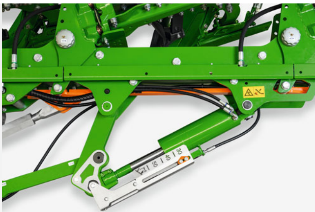
Réglage hydraulique de la largeur de travail
