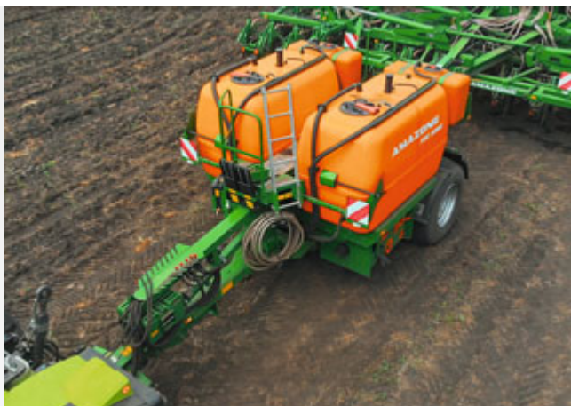
FDC 6000 avec une capacité de cuve de 6 000 l
