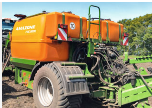
Deux cuves d'eau de rinçage de 300 l
