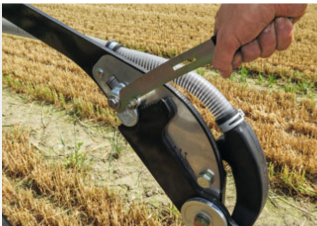
Réglage de la profondeur de la dent rapide et précis
