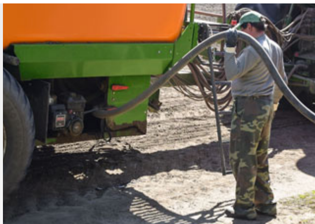
Remplissage rapide avec 500 l/min.
